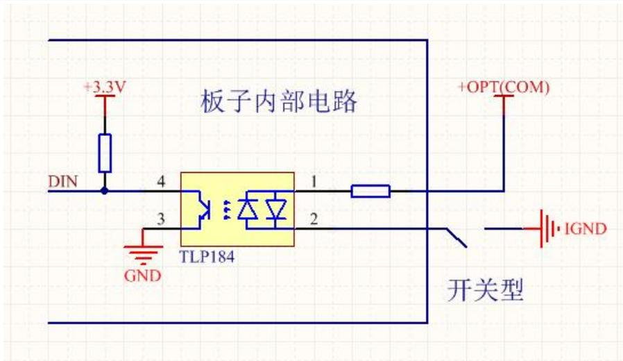
电压型信号输入：COM端接电源地，DI1-DI8端接电源电压(+12V~+24V)；
